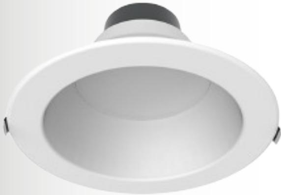
La luminaria downlight LED de grado arquitectónico proporciona la flexibilidad necesaria para asegurar el nivel de luz y la temperatura de color correctos deseados en diferentes aplicaciones. se pueden usar en nuevas construcciones o en aplicaciones de modernización/renovación. Los clips de resorte de acero inoxidable duraderos y resistentes a la corrosión se adaptan a techos de hasta 2" de grosor.
