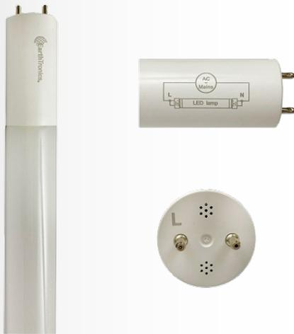
El cable directo de 15 vatios EarthBulb LED lineal T8 elimina el balasto para obtener el máximo ahorro de energía. Disponible en 5000K con un ángulo de haz de 300 grados. Gran salida de luz y perfecto para reemplazar tubos fluorescentes T8. Este tubo lineal proporciona 2200 lúmenes y tiene un CRI de 82. Esta lámpara está diseñada para un mantenimiento de alto lumen durante sus 50.000 horas nominales.
