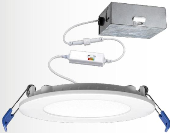
La luz descendente LED delgada de 6" con clasificación IC cuenta con cinco colores de operación seleccionables. Cambie entre 2700K, 3000K, 3500K, 4000K y 5000K fácilmente en el momento de la instalación. Estos accesorios delgados se pueden instalar fácilmente en paneles de yeso terminados o techos de baldosas arquitectónicas en aplicaciones comerciales y residenciales donde el espacio es un problema.
