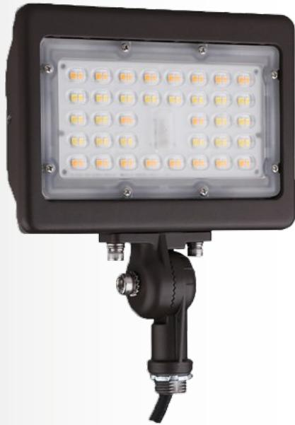
El reflector LED proporciona seguridad e iluminación general del área dirigida donde sea necesario. Acabado en polvo de bronce arquitectónico texturizado con lente acrílica de alto impacto. Este reflector de 30 vatios funciona con una eficiencia de 114 lúmenes por vatio. Cambia entre 3000K, 4000K y 5000K.
