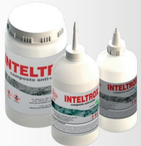
Compuesto antióxido con partículas de cobre suspendidas en vehículo viscoso para garantizar conexiones eléctricas bajas resistencia. Aplicado alrededor de un conductor eléctrico, INTELTROX-Cu reúne un gran número de puntos conductores. INTELTROX-Cu, debido a la acción antioxidante (tipo amina) de sus aditivos y a su insolubilidad en agua, gas o aceite, elimina el aire y la humedad entran en las conexiones, evitando la corrosión y la oxidación. El uso de INTELTROX-Cu está indicado para Cu-Cu
