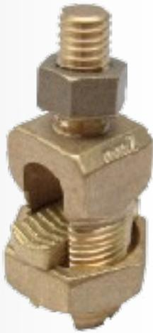
Conexión con cables CS - COPPERSTEEL o cobre. Se utiliza para alinear uno o dos cables de bajada en estructuras metálicas, fachadas de edificios o tejados. Conecte a tierra uno o dos cables a estructuras de acero, láminas y barras colectoras. Se suministra con tuerca en la coleta.
